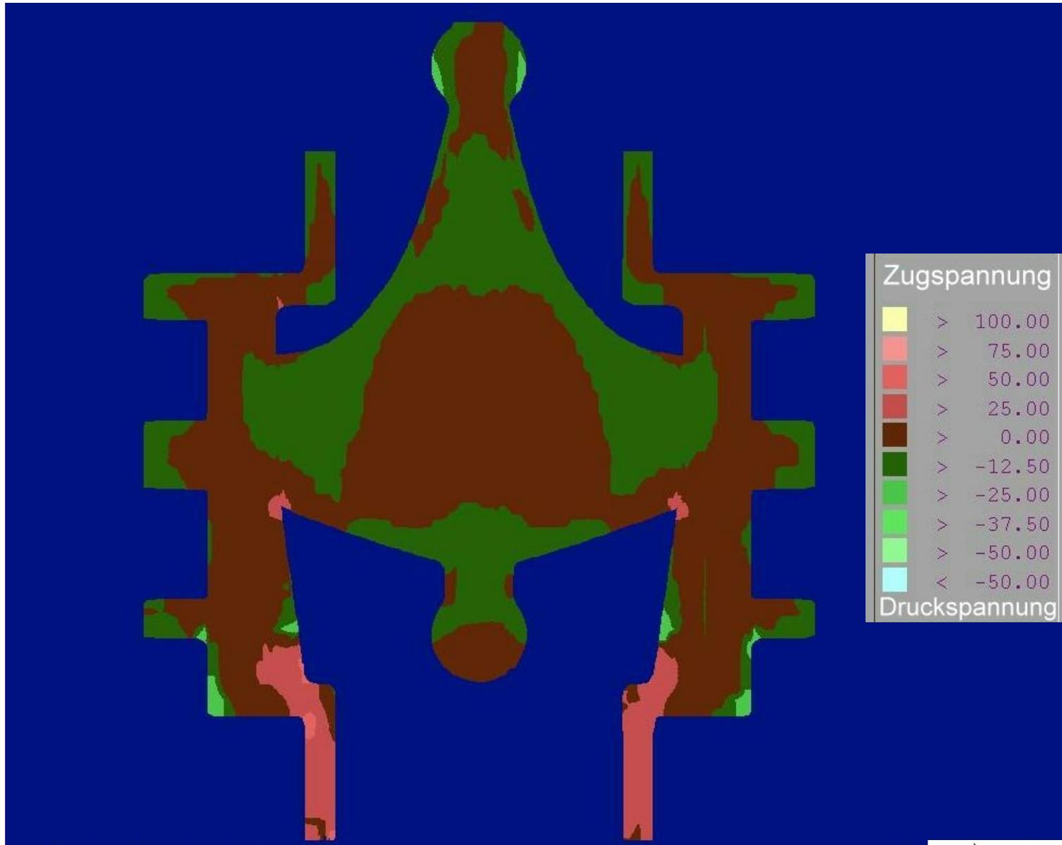
Zug- und Druckspannungsverteilung im Schnitt
