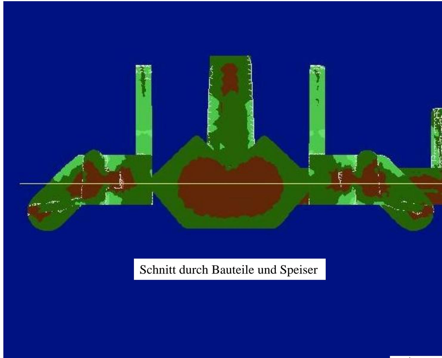
Schnitt durch Bauteile und Speiser
